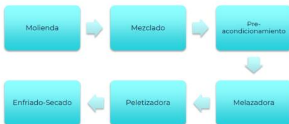
Ilustración 1. Proceso productivo de alimentos concentrados para animales.
