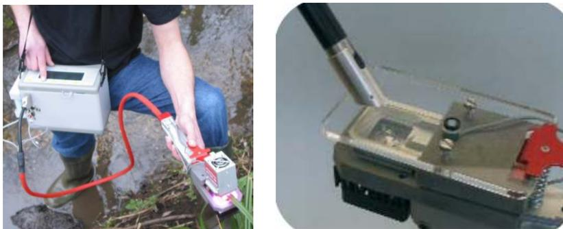
**Figura 3.** Equipo LCpro-SD para mediciones de intercambio gaseoso (CO<sub>2</sub>/H<sub>2</sub>O) (0-2000 ppm) y H<sub>2</sub>O (0-75 mb), adaptación en la cubeta del LCpro-SD para medición de fluorescencia de la clorofila en plantas.
