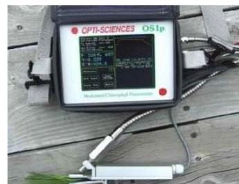
**Figura 8.** Unidad de luz para cubeta de hojas anchas del LCpro T, adaptación en cubeta del LCpro T para mediciones de Fluorescencia (sin unidad de luz) y consola independiente para medición de fluorescencia.
