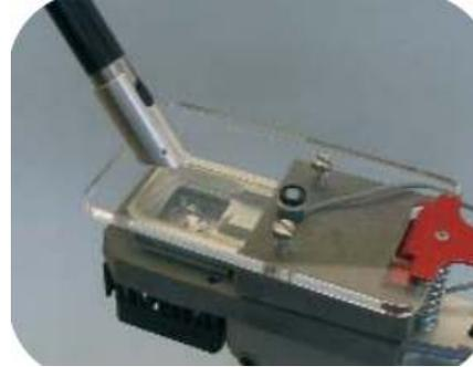
**Figura 9.** Unidad de luz para cubeta de hojas anchas del LCpro –SD y adaptación en cubeta del LCpro-SD para mediciones de Fluorescencia (sin unidad de luz).
