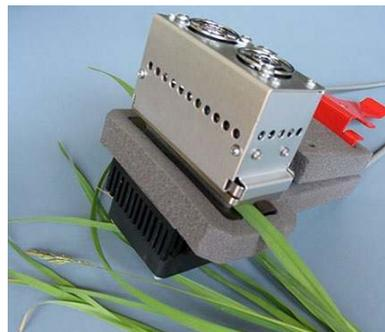
**Figura 6.** Cubeta del LCpro-SD para hojas anchas y cubeta para hojas angostas con sus correspondientes unidades de luz.
