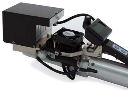
**Figura 1.** Sistema CIRAS-3 con módulo de fluorescencia para mediciones simultáneas de intercambio gaseoso ( $\text{CO}_2/\text{H}_2\text{O}$ ) (0-2000 ppm) y  $\text{H}_2\text{O}$  (0-75 mb) y Fluorescencia de la clorofila en plantas en un solo equipo.
