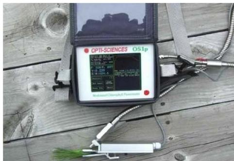
**Figura 2.** Equipo LCpro T para mediciones de intercambio gaseoso ( $\text{CO}_2/\text{H}_2\text{O}$ ) (0-2000 ppm) y  $\text{H}_2\text{O}$  (0-75 mb), adaptación en cubeta para medición de fluorescencia de la clorofila en plantas y equipo adjunto OS1p para registro de datos de fluorescencia.
