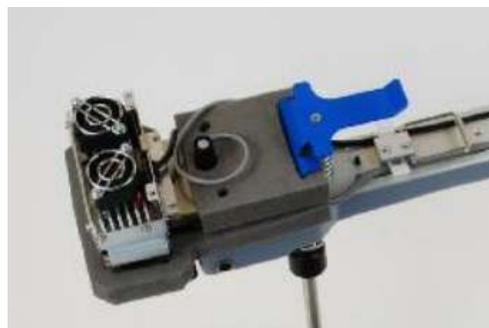
**Figura 5.** Cubeta del LCpro T para hojas anchas y cubeta para hojas angostas con sus correspondientes unidades de luz.
