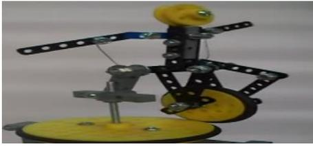
El mecanismo de entrada de movimiento es el más simple: Ruedas de fricción. Este ejemplo muestra la versatilidad del material y el amplio rango de uso tanto a nivel de entretenimiento como didáctico.
